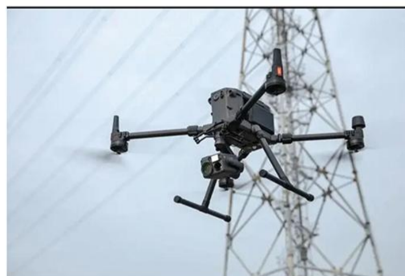
输电杆塔精细化巡检
